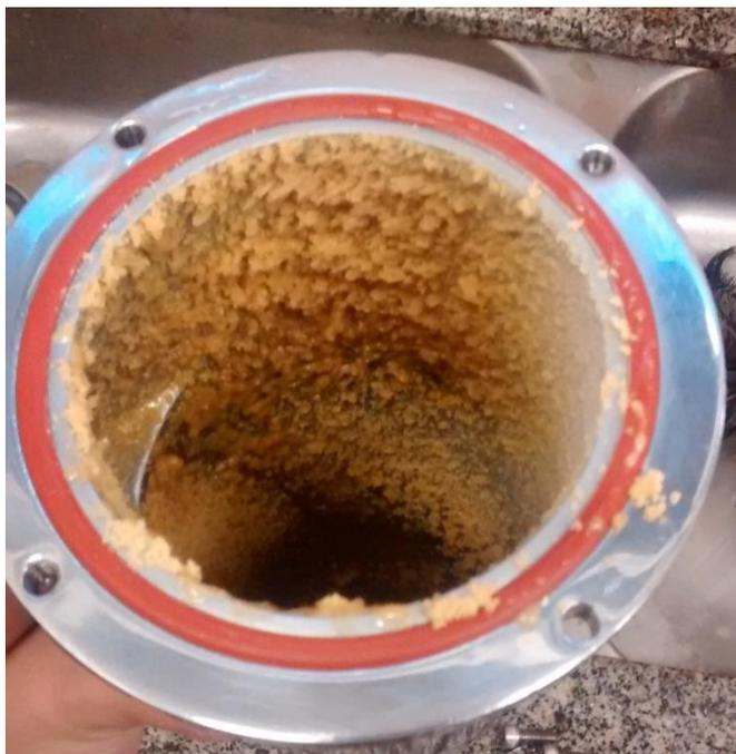
**Figura 7-** Imagem do ciclone do *spray dryer* após processo de encapsulação.
