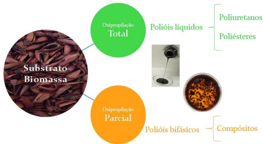
Figura 4. Uma visão integrada dos produtos gerados através da reação de oxipropilação e sua posterior utilização na produção de poliuretanos, poliésteres e compósitos (Adaptada de Pinto, 2015).
