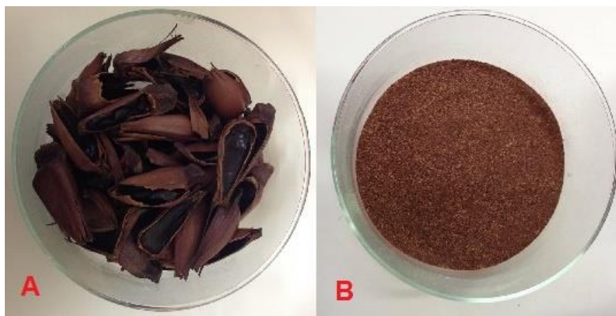
Figura 6. (A) Casca de pinhão antes de triturar; (B) Casca de pinhão depois de triturar destinada aos ensaios de oxipropilação total.
