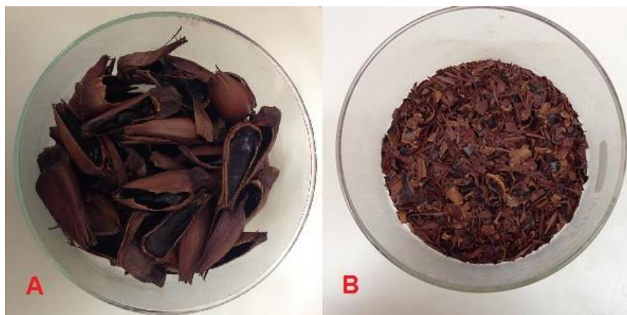
Figura 7. (A) Casca de pinhão antes de triturar; (B) Casca de pinhão após ser triturada e peneirada destinada aos ensaios de oxipropilação parcial.
