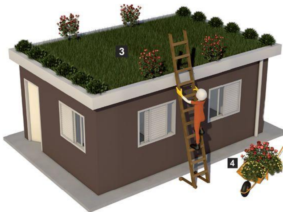
Figura 4: Representação de telhado verde semi-extensivo. Fonte: CORSINI, 2011
