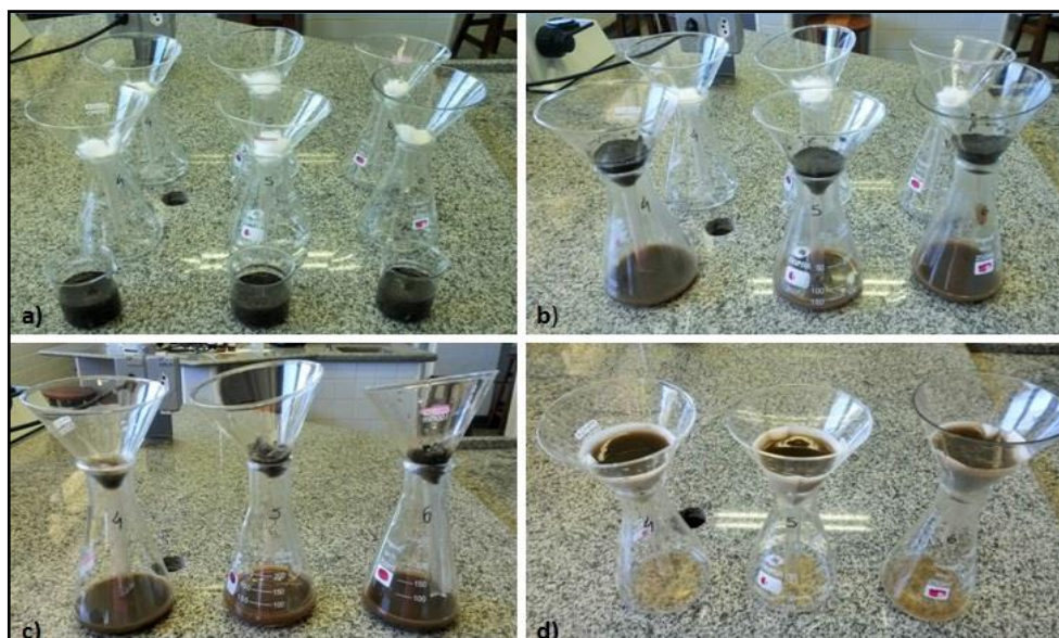
Figura 8 - Amostras (iniciais) sem qualquer filtração (a); amostras após a primeira filtração com algodão (b); amostras após a segunda filtração com algodão (c); filtração com papel filtro (d).
