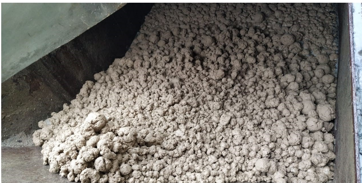
Figura 2: Caçamba armazenadora do lodo
