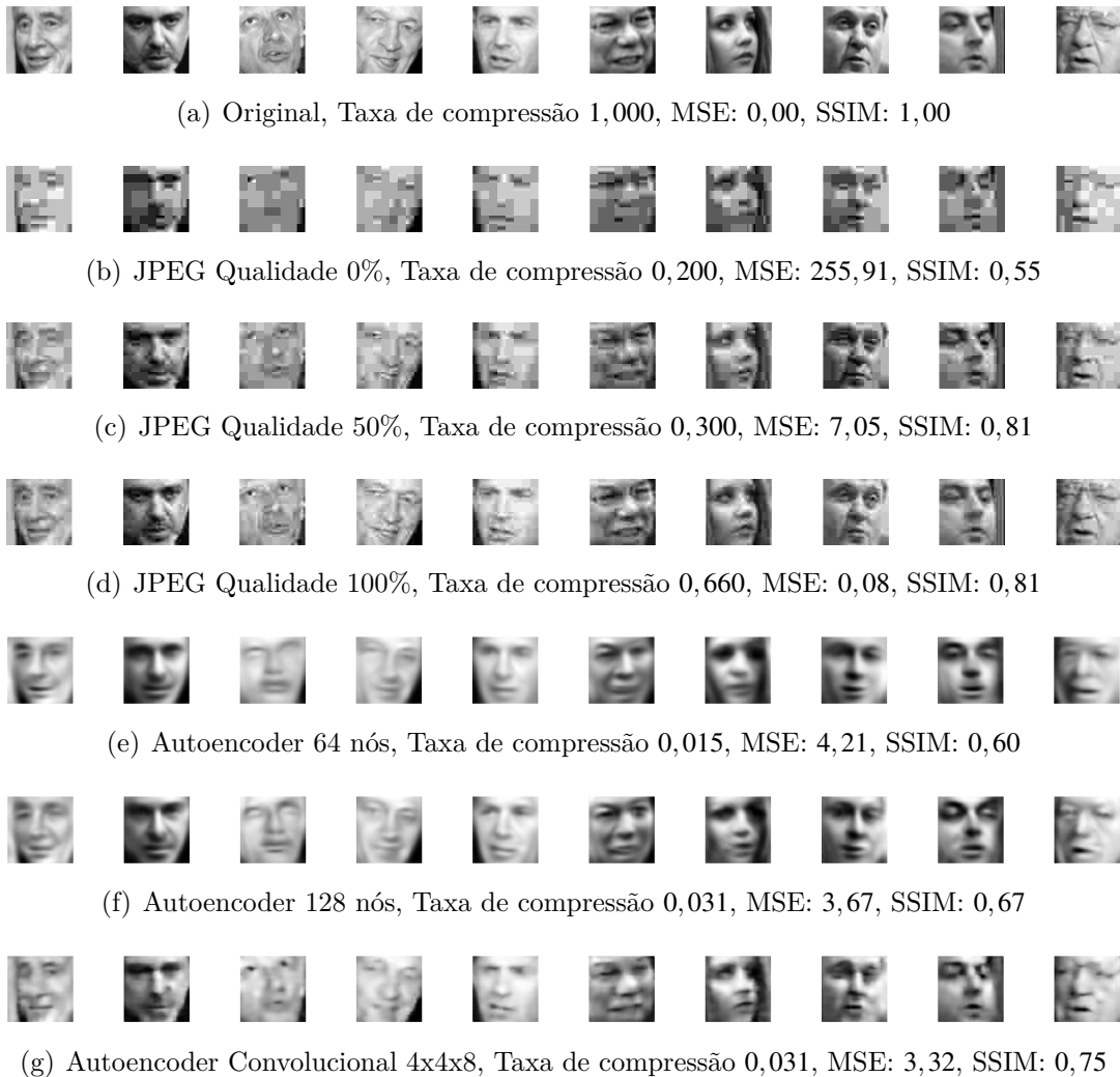
Figura 12 – Amostra de resultados de compressão com conjunto em escala de cinza
