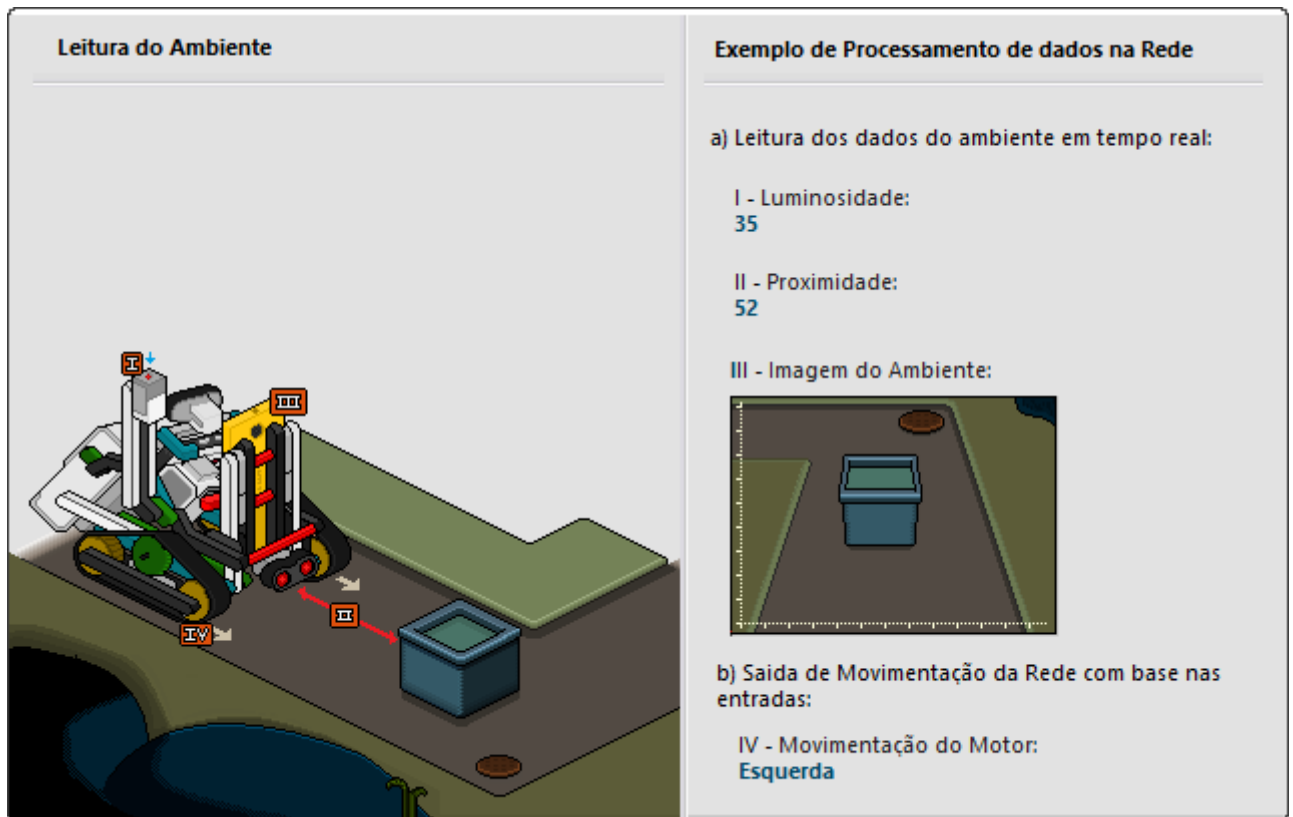
Figura 34 – Representação de Processamento de Dados na Rede Convolucional com sua Resposta .
