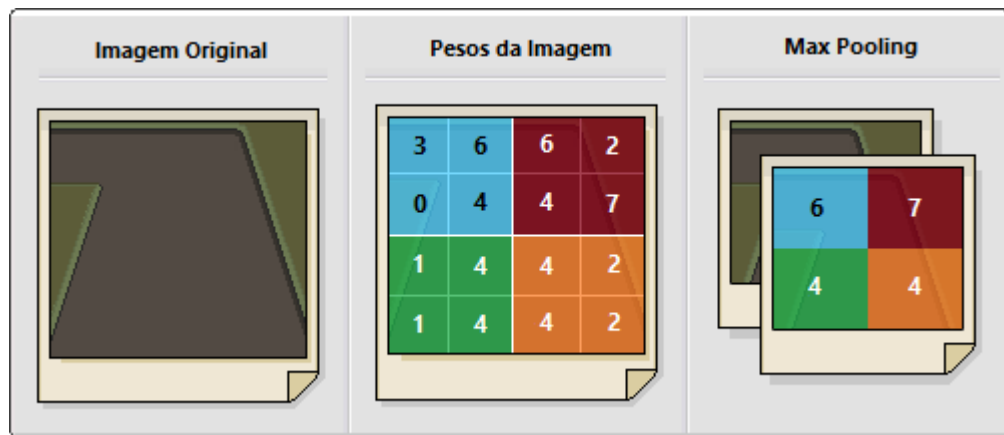
Figura 14 – O uso do algoritmo de Max-Pooling nos pesos de uma imagem
