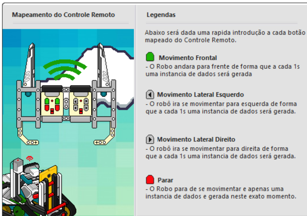
Figura 26 – Representação do controle remoto e o mapeamento dos botões e suas ações durante a captura de dados do ambiente para a geração das instâncias do futuro conjunto de treinamento.
