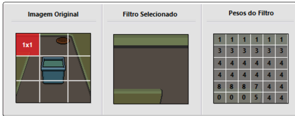
Figura 13 – Exemplo de Extração de Pesos de um pedaço da imagem com um filtro 1x1
