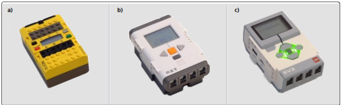
Figura 24 – Versões do Microcontrolador do Kit Lego Mindstorms: (a) RCX; (b) NXT; (c) EV3 Fonte: Autoria Própria
