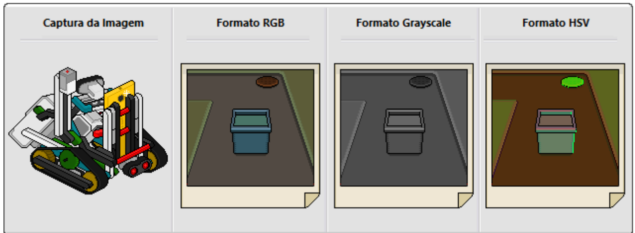
Figura 30 – Representação de conversão da imagem do ambiente para diferentes canais de cores.
