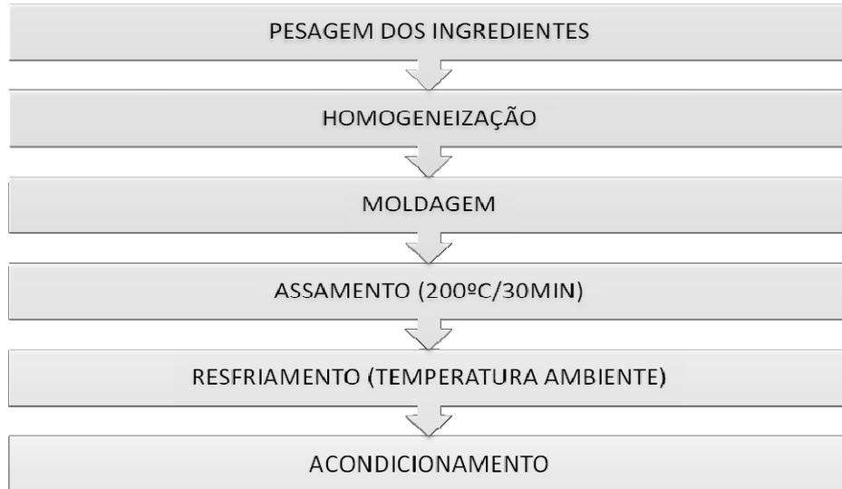
**Figura 2 – Diagrama de blocos do processamento das formulações de biscoitos.**
