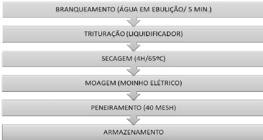
**Figura 1 – Diagrama de blocos do processamento da farinha integral de soja.**
