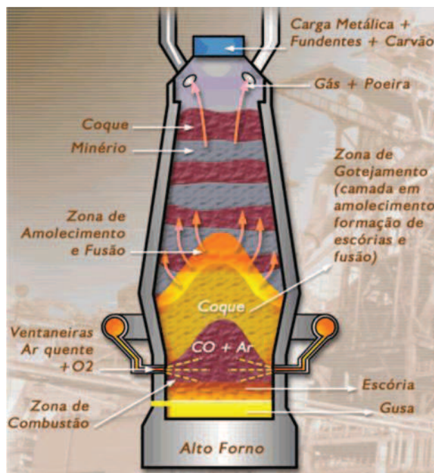
Figura 4 - Representação esquemática de um alto-forno. Fonte: (FRANCINO 2008)
