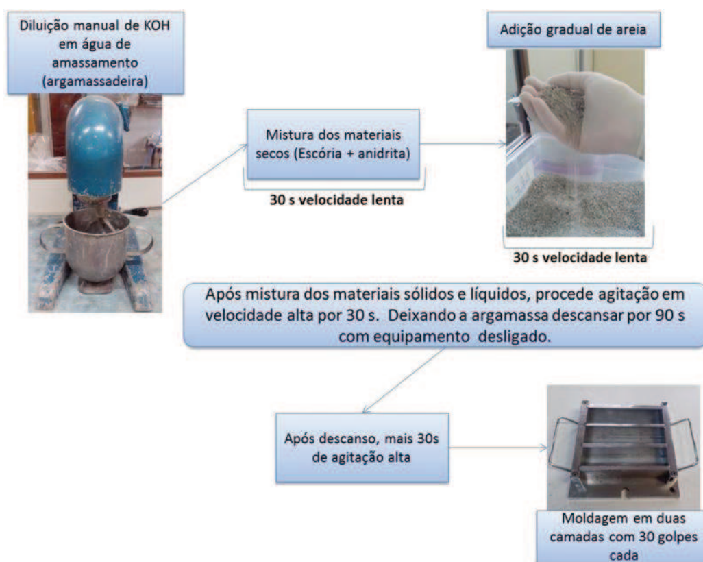
Figura 15 - Procedimento para elaboração da argamassa. Fonte: Pessoal.
