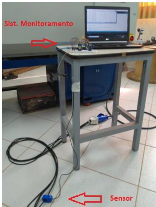
Figura 25. Montagem do sistema de monitoramento junto ao torno
