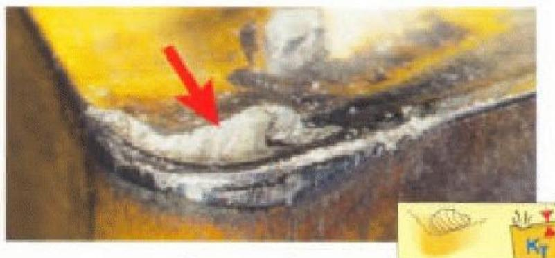
**Figura 12. Desgaste de cratera em um inserto de corte.**
