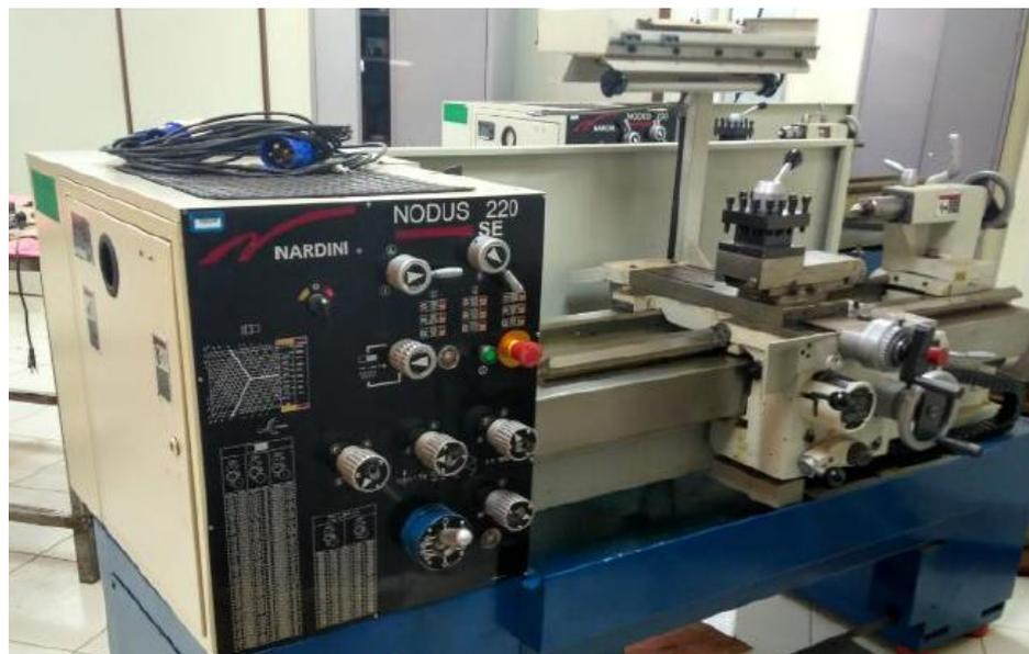
**Figura 20. Torno mecânico convencional**
