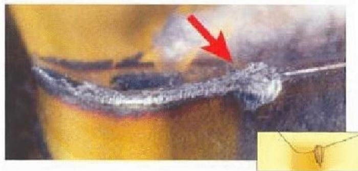
**Figura 13. Desgaste de entalhe em um inserto de corte.**
