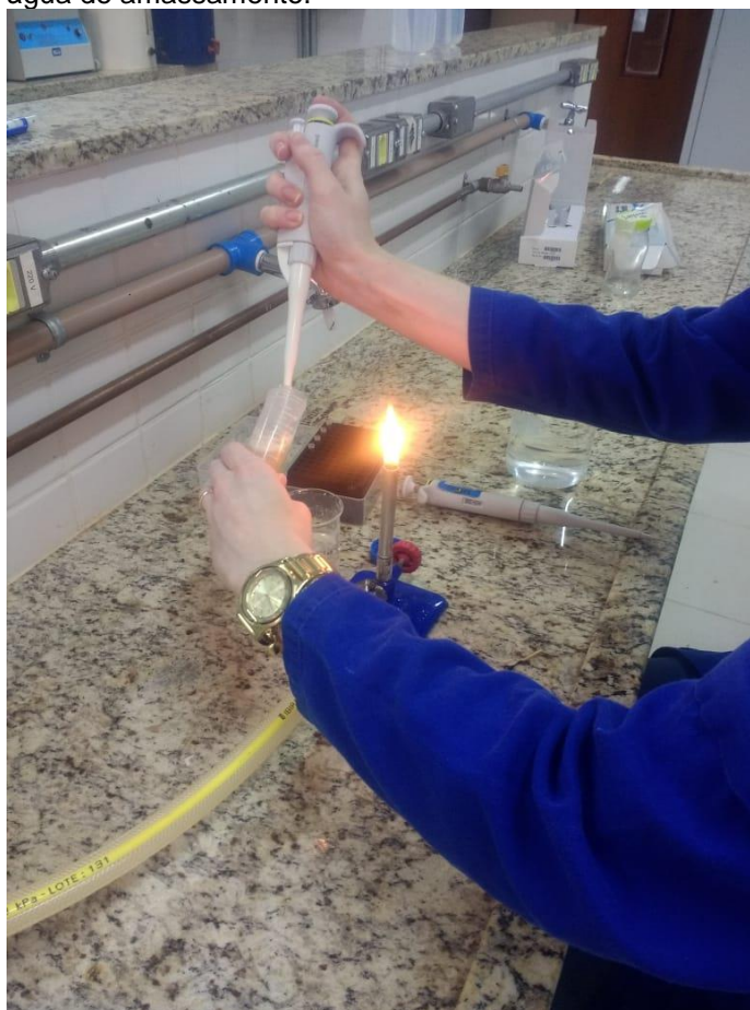
Figura 13- Bactéria sendo pipetada para ser colocada na água de amassamento.
