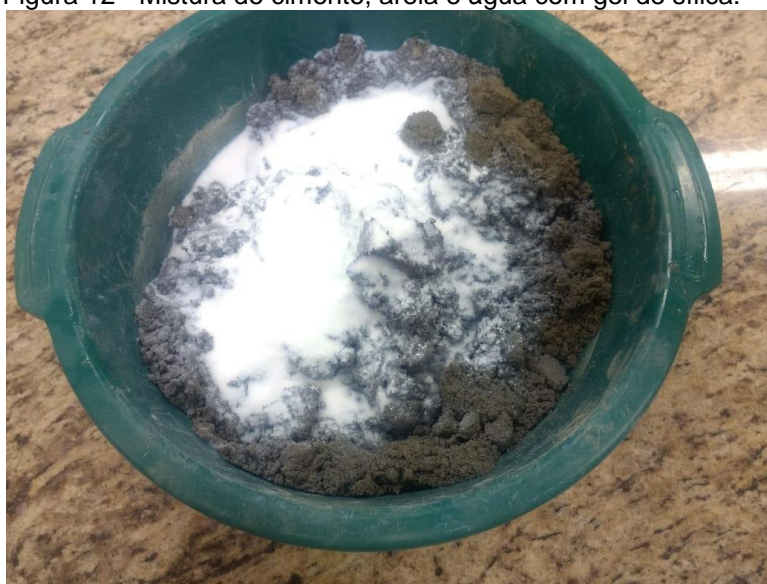
Figura 12 - Mistura de cimento, areia e água com gel de sílica.
