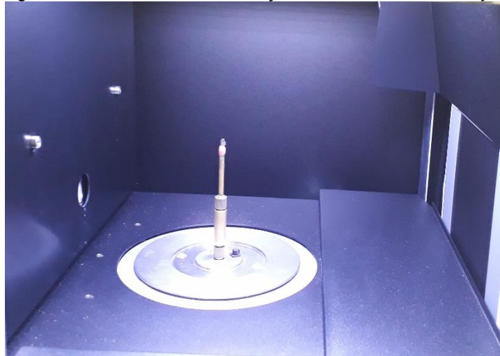
Figura 10 – Detalhamento da seção interna do sistema Skyscan com a amostra.
