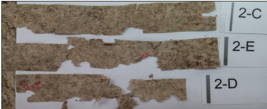
Figura 21 – Corpos de prova de PBAT+20% retirados após 35 dias
