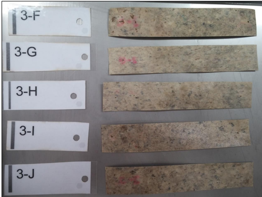
Figura 25 – Corpos de prova de PBAT-TPF (20%) retirados após 60 dias
