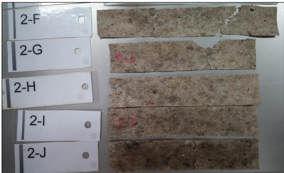
Figura 24 – Corpos de prova de PBAT+20% retirados após 60 dias
