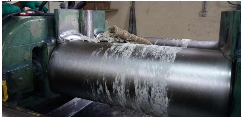
Figura 10 - Processamento da borracha em um misturador aberto de cilindros
