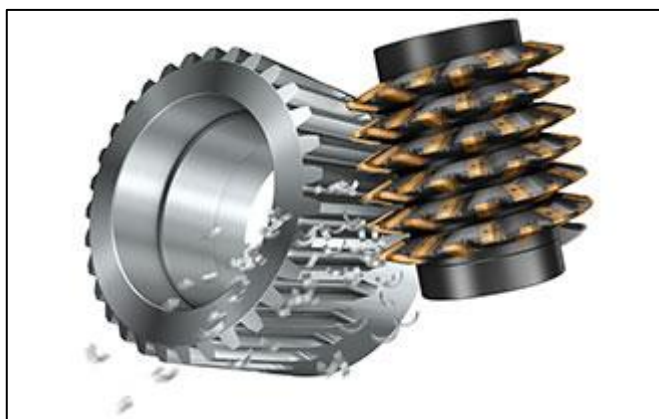
Figura 8 – Esquema do processo hobbing
