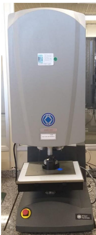
Figura 24 – Equipamento para obtenção do perfil de dureza
