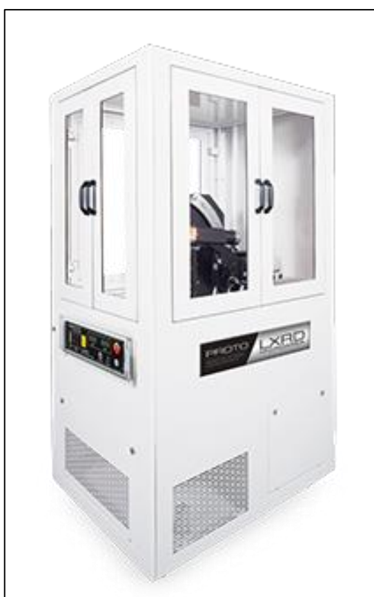
Figura 22 – Equipamento LXRD análise de tensão residual e austenita retida
