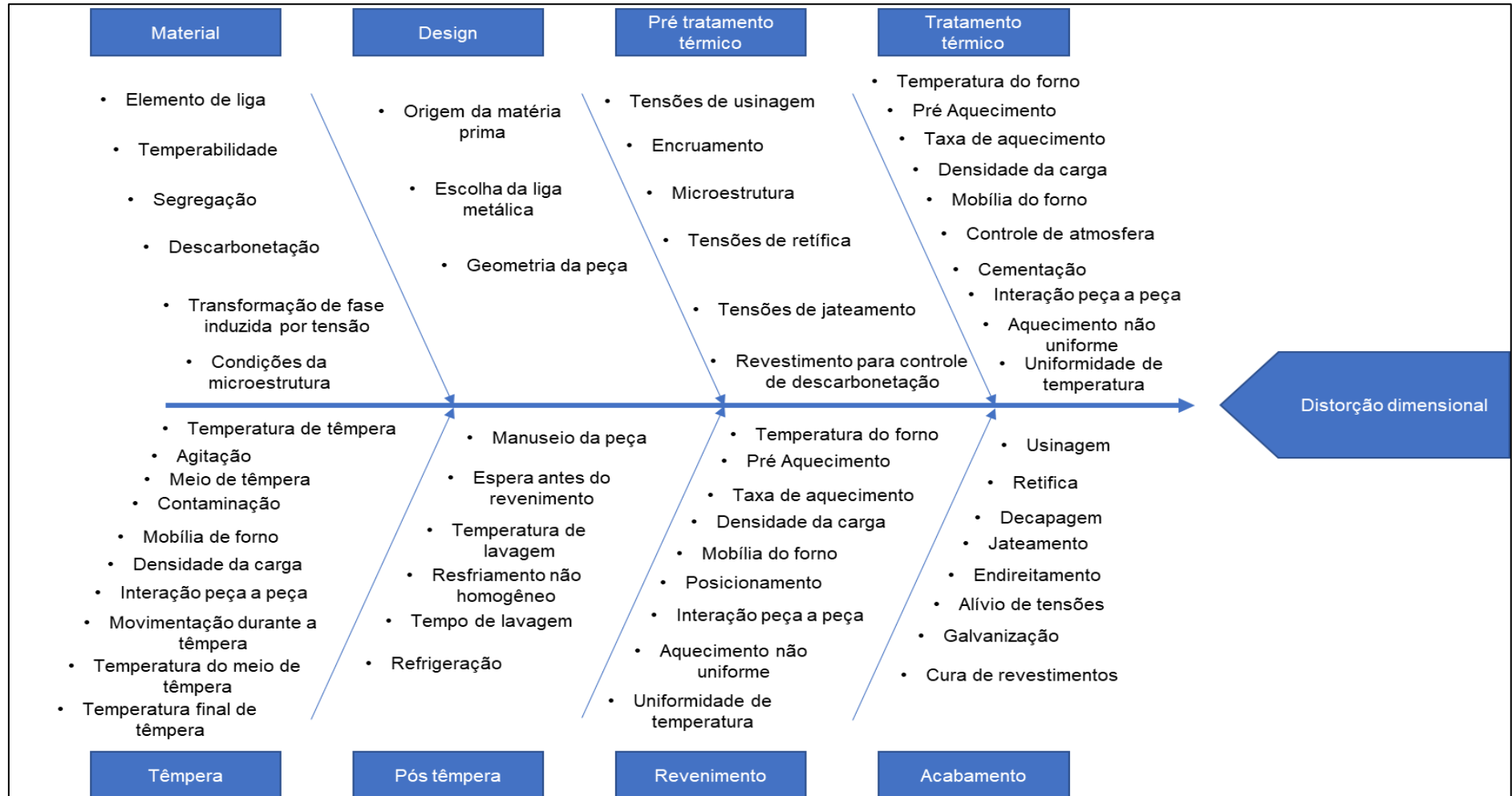
Figura 16 – Diagrama de Ishikawa com diversos fatores que afetam a distorção
