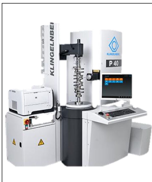
Figura 19 – Máquina Klingelberg GmbH: Centro de medição de engrenagens
