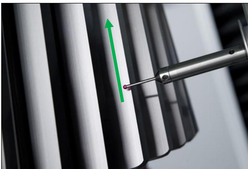
Figura 20 – Direção de leitura do passo do dente pelo apalpador
