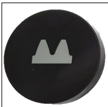
Figura 25 – Amostra embutida a quente com baquelite
