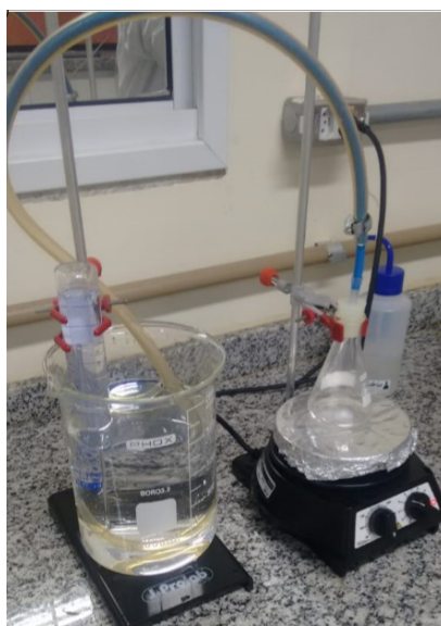
Figura 5 - Aparato experimental para realização da degradação de \text{H}_2\text{O}_2
