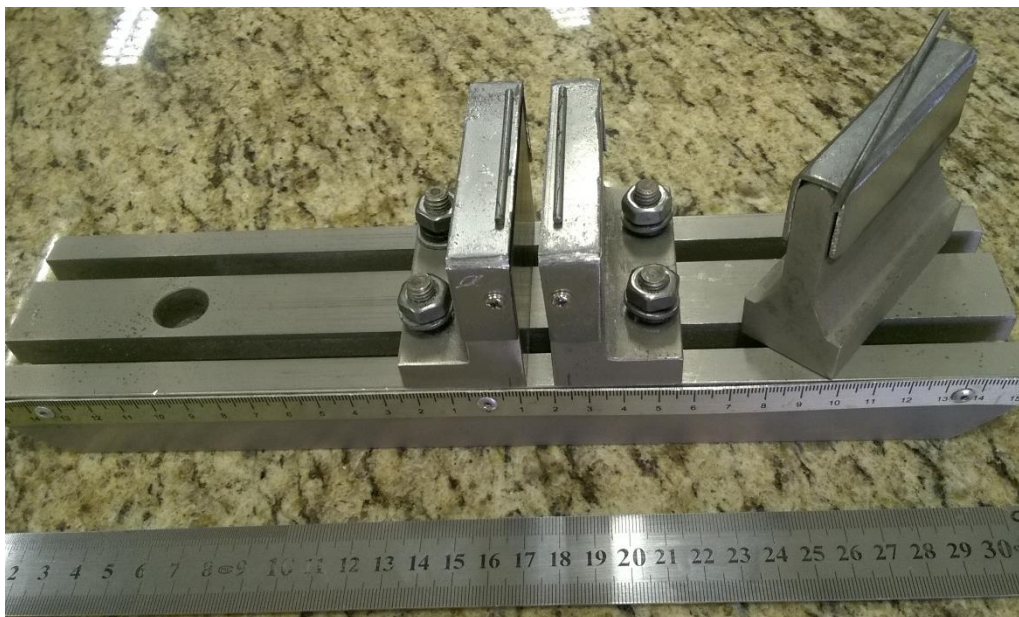
Figura 8 - Adaptação de aparato para execução de ensaios de flexão.
