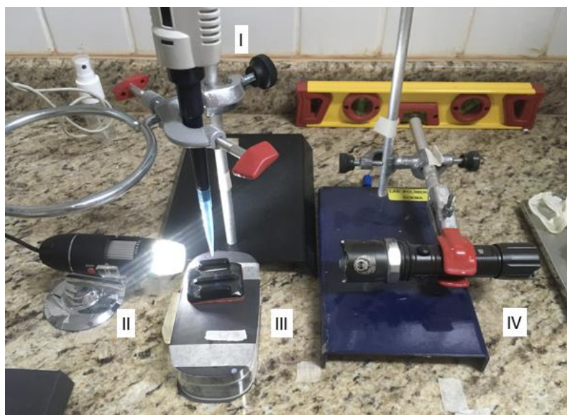
Figura 7 – Goniômetro construído para análise do ângulo de contato. I – Micropipeta; II – Câmera microscópica; III – Suporte-base, IV – Lanterna.
