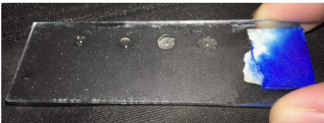
Figura 16 – Gotas de água fixadas (sem ângulo de rolamento) sobre a superfície da amostra LE1 após aplicação do revestimento.
