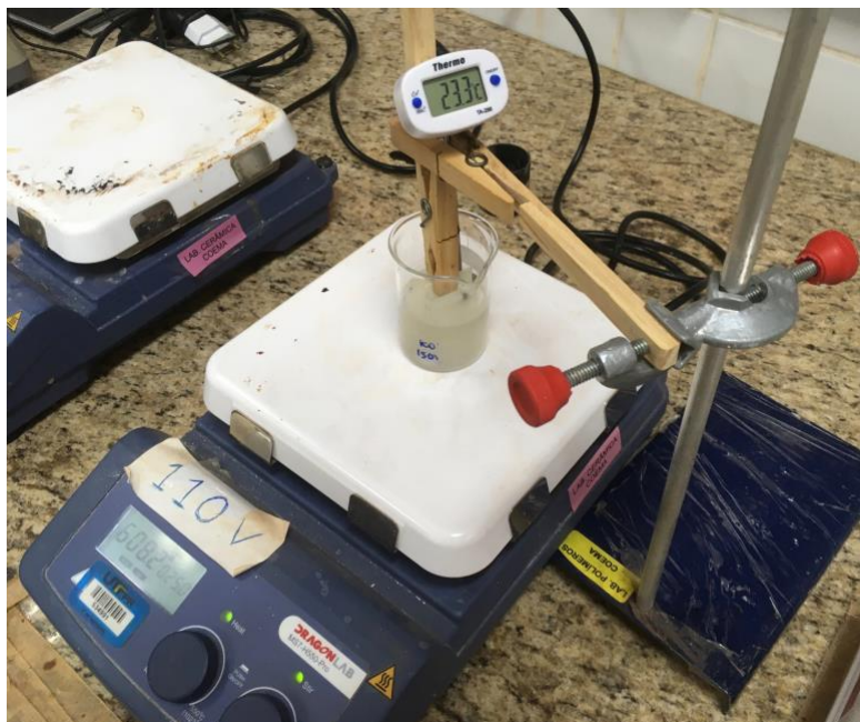
Figura 9 – Procedimento de ativação superficial via básica (KOH/Isopropanol) utilizando agitador magnético.
