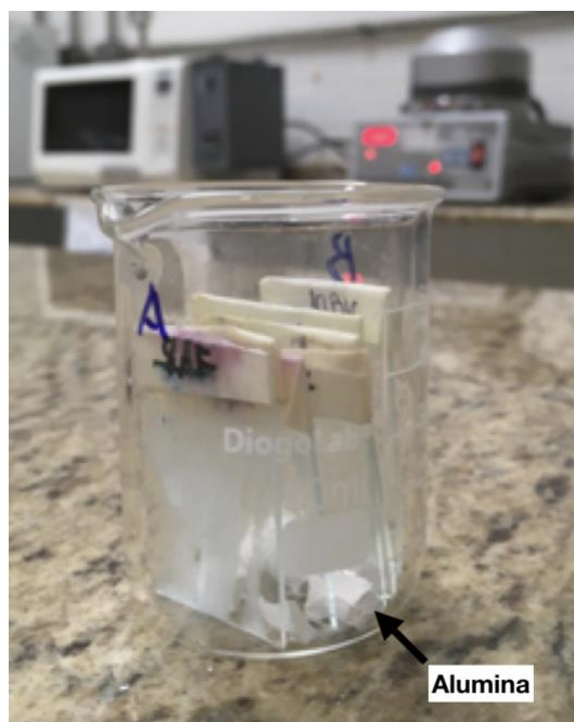
Figura 11 – Primeira etapa do procedimento de silanização. Amostras: LA8 a LA10 a frente e LB8 a LB10 mais ao fundo.
