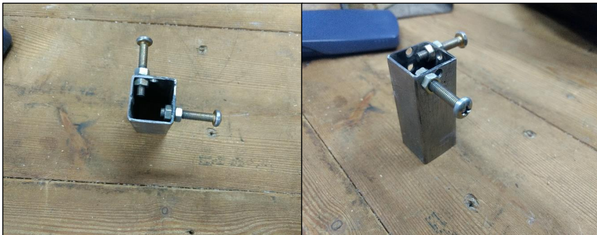
Figura 22 - Porta amostra com parafusos para fixação e alinhamento
