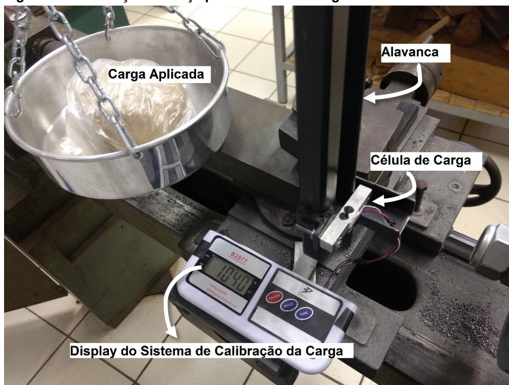
Figura 24 - Calibração da força para o ensaio de desgaste
