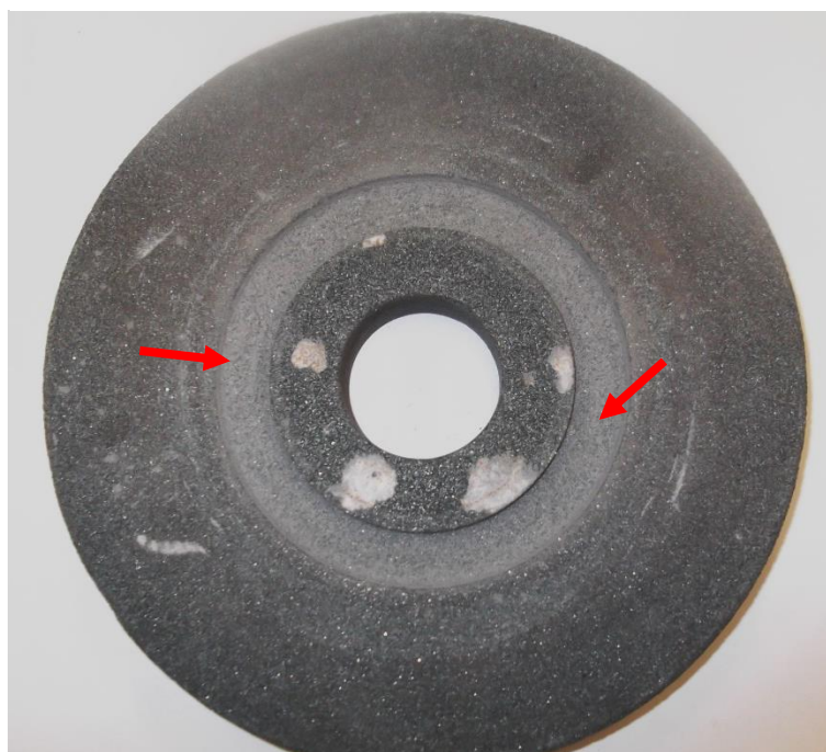
Figura 26 - Rebolo com desgaste profundo após ensaio de 50 N
