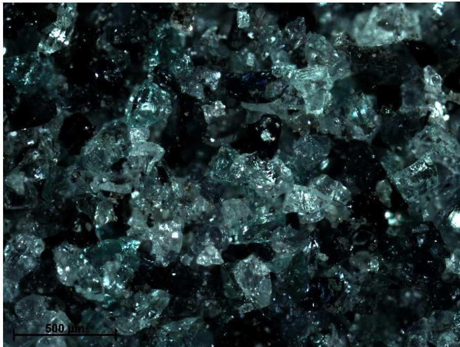
Figura 34 - Micrografia da superfície do rebolo em campo escuro. Aumento de 50x.
