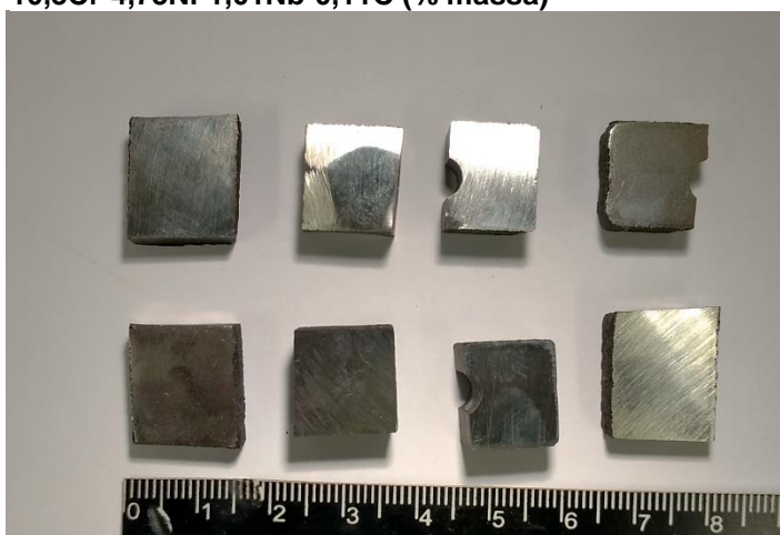
Figura 19 - Corpos de prova da liga Fe-16Mn-5,74Si-10,3Cr-4,73Ni-1,01Nb-0,11C (% massa)
