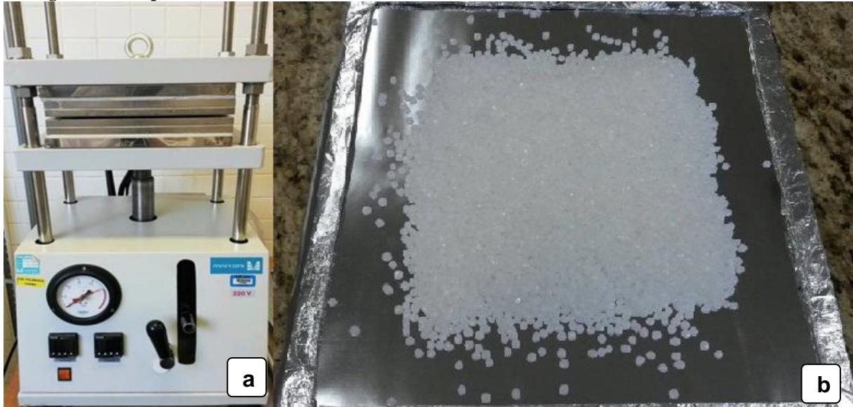
Figura 12 - (a) Prensa Hidráulica. (b) Chapa inferior e paredes laterais do molde utilizado (revestidos com papel alumínio). No centro, quantidade de material ( pellets de PEAD) utilizado, momento antes da moldagem via compressão.
