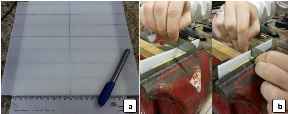
Figura 14 - (a) Marcação nas placas das dimensões dos CP's para o método EWF. (b) Introdução dos entalhes laterais.
