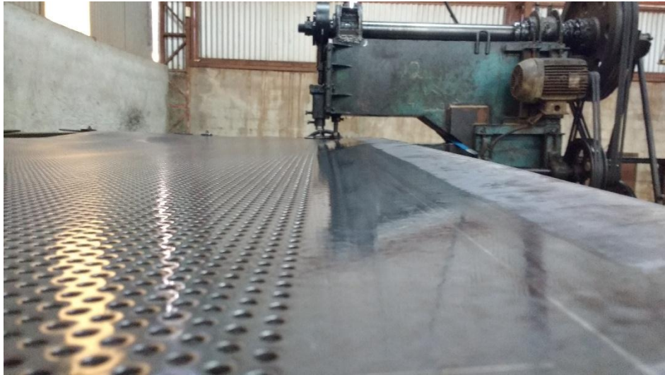
Figura 7 - Processo de Perfuração das chapas
