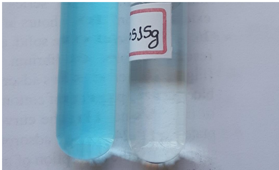
Figura 15: Diferença de coloração entre a solução com 1,5 \times 10^{-5} mol.L -1 de azul de metileno (esquerda) e a mesma solução após purificação com o filtro 1 (direita).
