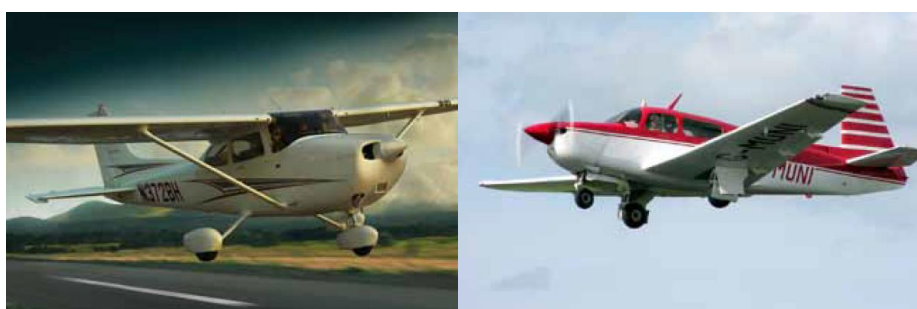
Figura 2 – Aeronave com trem de pouso fixo (esquerda) e com trem de pouso retrátil (direita)
