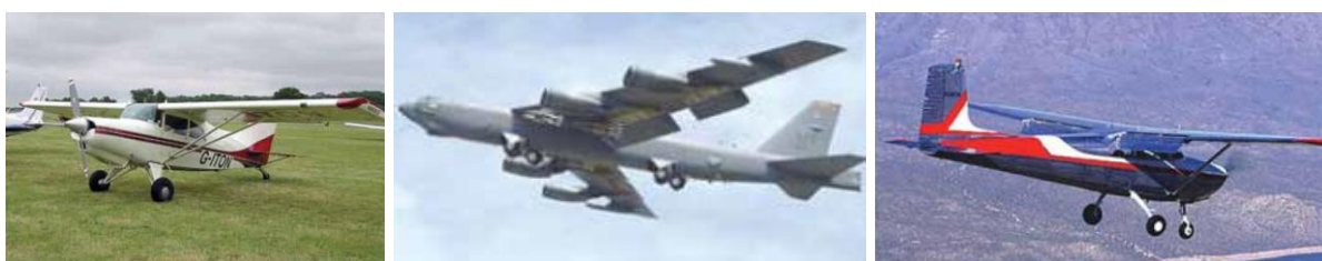
Figura 3 – Aeronave com trem de pouso convencional (esquerda), tandem (centro) e triciclo (direita)
