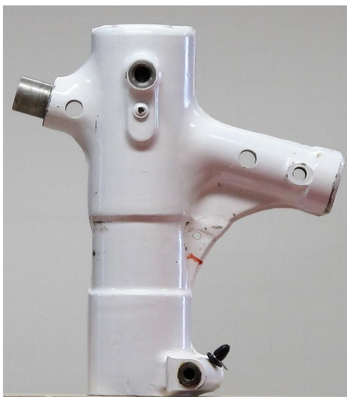
Figura 10 – Amortecedor de impacto falhado do PT-DIS.
