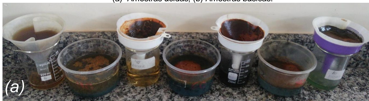
Figura 18 - Amostras após a eletrocoagulação com e sem filtração. (a) Amostras ácidas; (b) Amostras básicas.
