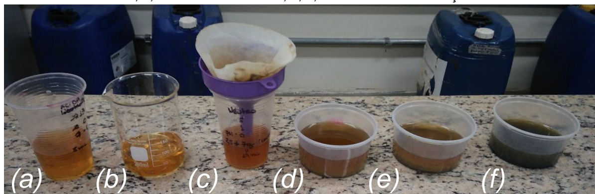
Figura 17 - Amostra neutra após a eletrocoagulação. a, b, c – amostras filtradas; d, e, f – amostras sem filtração
