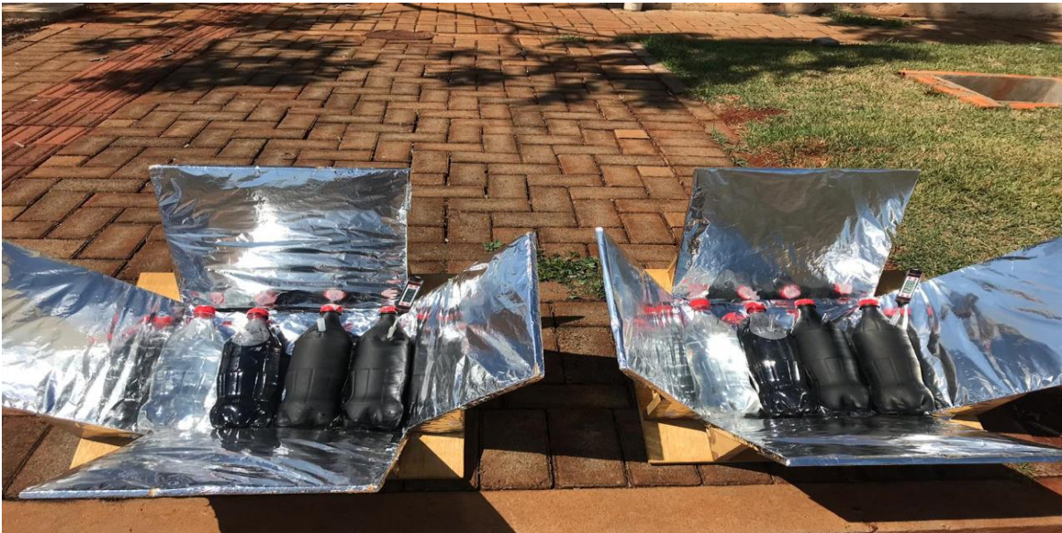
Figura 14 – Garrafas expostas a radiação no concentrador solar
