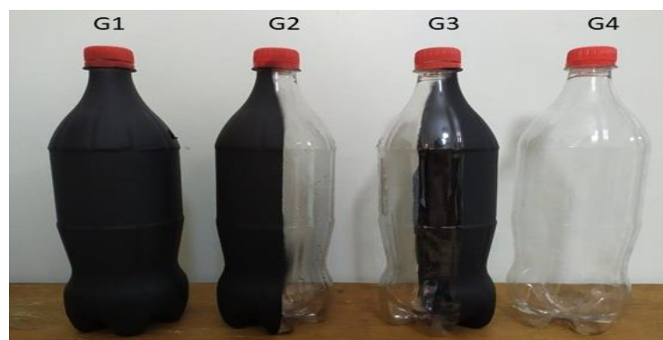
Figura 13 – Garrafas tipo PET utilizadas no concentrador solar.
