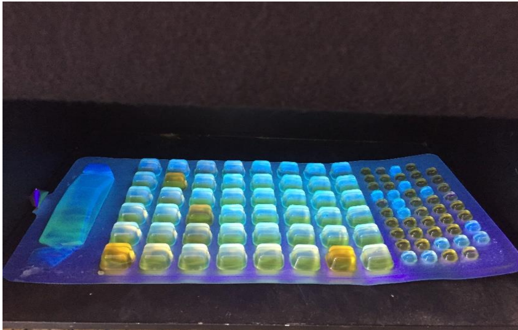
Figura 16 - Câmara escura com luz UV para contagem de E. coli
