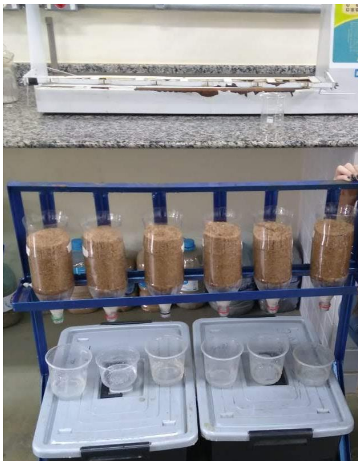
Figura 8: Filtros montados e posicionados
