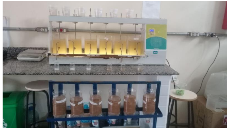
Figura 6- Aparato experimental completo, Jar-Test e filtros
