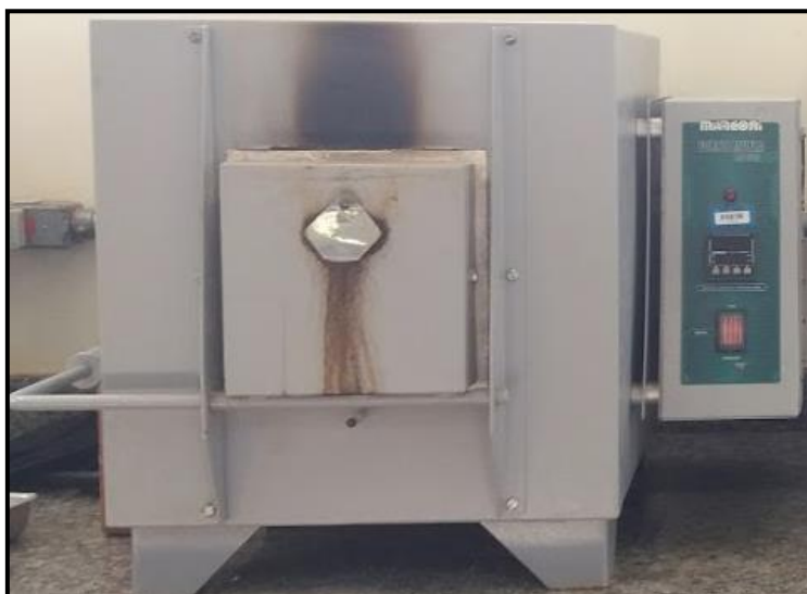
Figura 8 – Mufla. Modelo: Marconi MA 385.
