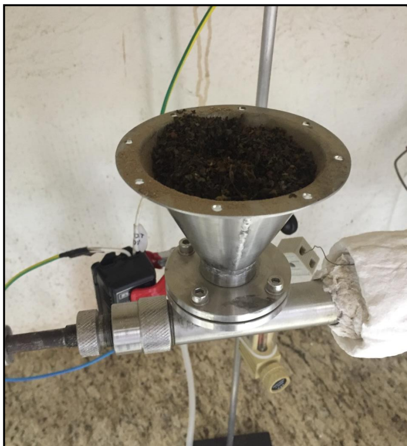
Figura 15 – Biomassa de lenhas no alimentador do sistema de pirólise.
