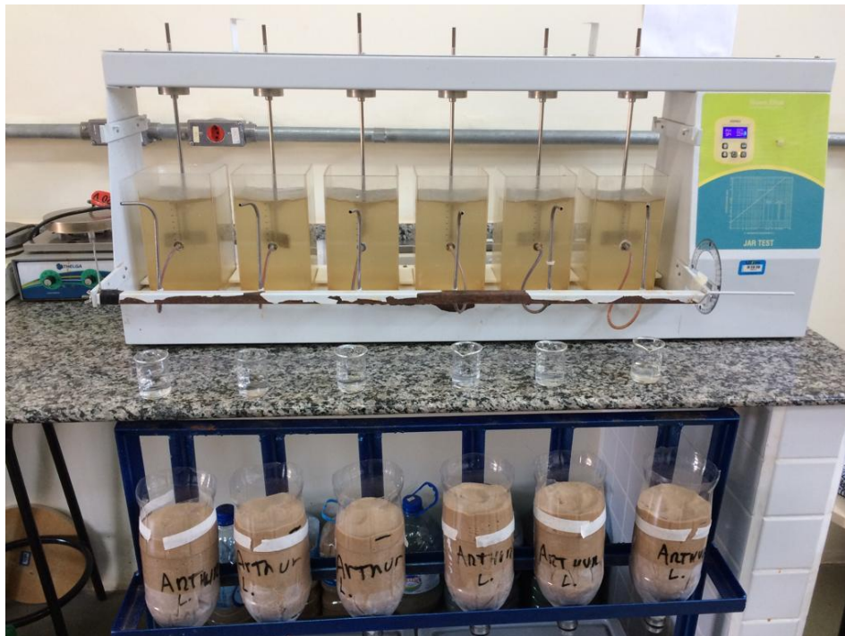
Figura 3: Jar-test e filtros de areia utilizados no experimento.
