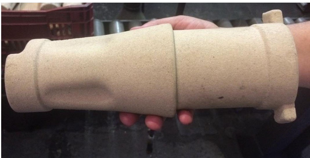
Figura 3 – Exemplo de molde em processo de compactação da areia.
