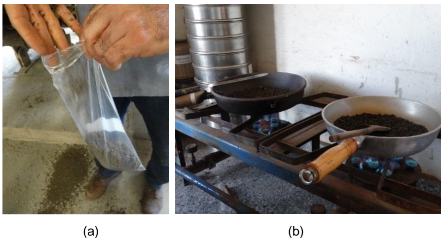
Figura 15 – Teor de umidade: (a) coleta amostra; (b) secagem pelo método da frigideira.
