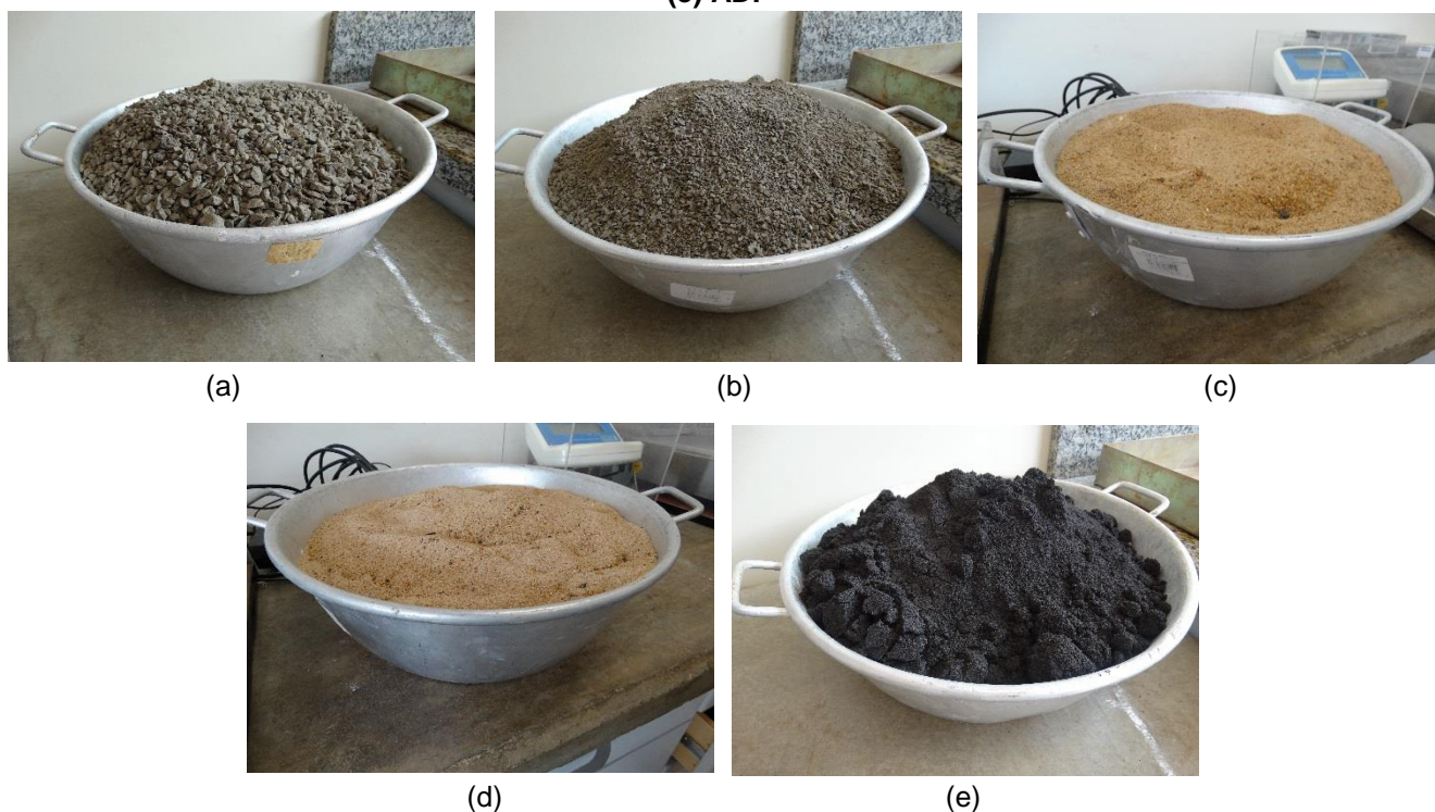
Figura 7 – Agregados: (a) pedrisco; (b) pó de pedra; (c) areia media-grossa; (d) areia fina; (e) ADF
