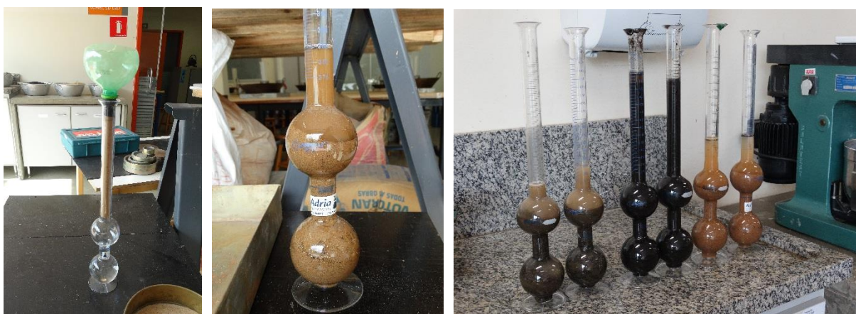
Figura 9 – Metodologia frasco de Chapman: (a) Frasco de Chapman; (b) Frasco com água e agregado; (c) Leitura Final;
