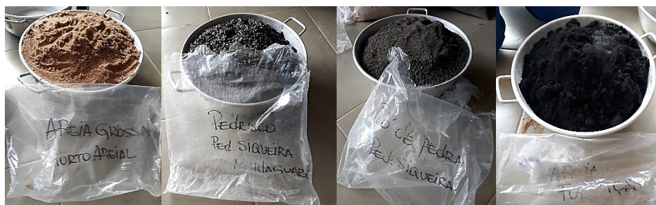
Figura 7 - Amostra de areia grossa, pedrisco, pó de pedra e ADF
