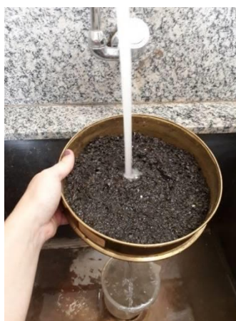
Figura 9 - Processo de lavagem do pó de pedra para determinação de material pulverulento.
