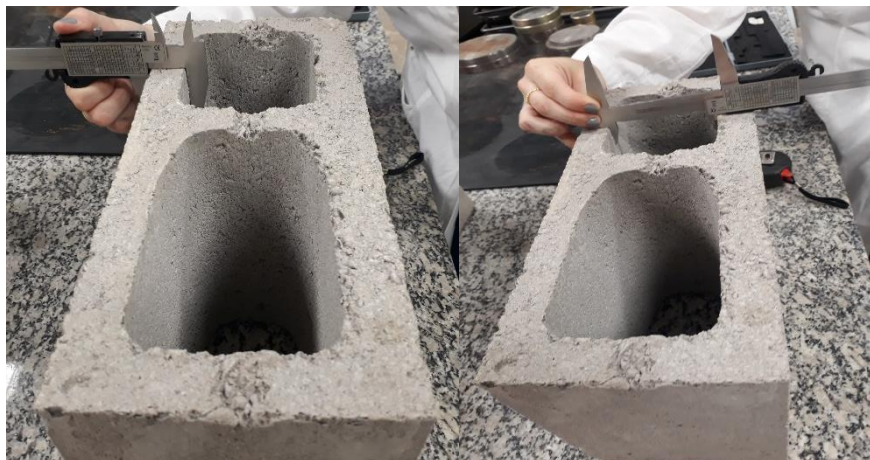
Figura 11 - Medição da parede transversal e do furo do bloco de concreto
