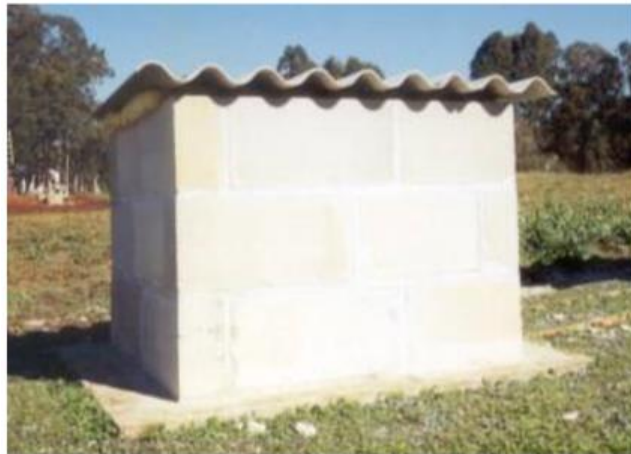
Figura 6 - Test-cell de bloco de concreto celular
