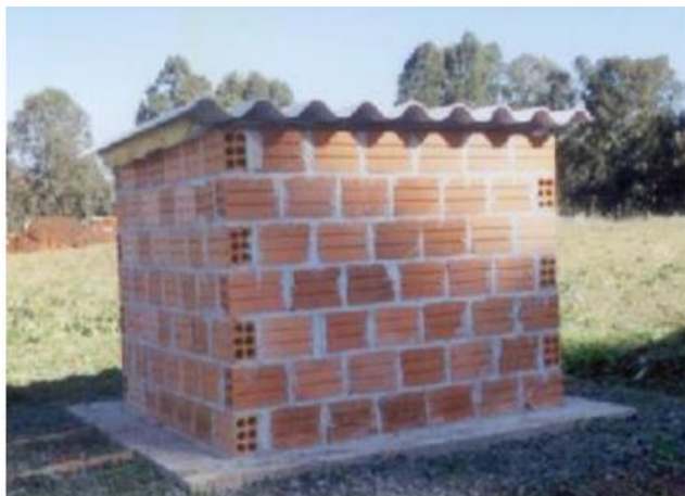
Figura 7 - Test-cell de bloco cerâmico
