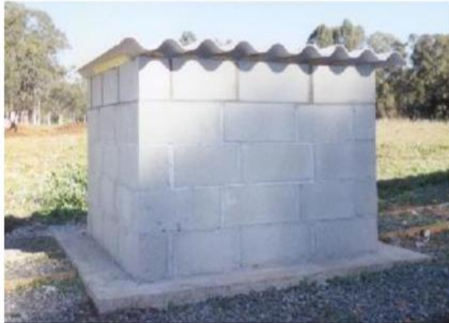
Figura 5 - Test-cell de bloco de concreto tradicional
