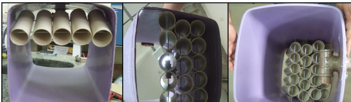
Figura 11 - Montagem do Decantador Laminar.
