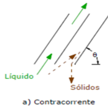
Figura 6 - Geometria e Fluxo de Decantador Laminar Contracorrente
