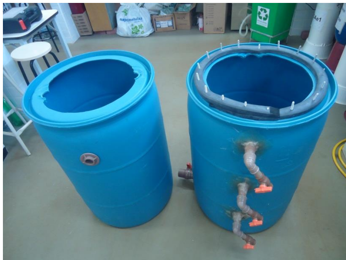
Figura 10 - Bombonas utilizadas no experimento (Flange de Borracha e parafusos para vedação do reator).
