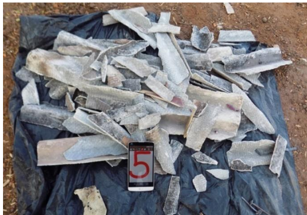
Figura 41- Predominância de telhas de amianto em ponto amostral.
