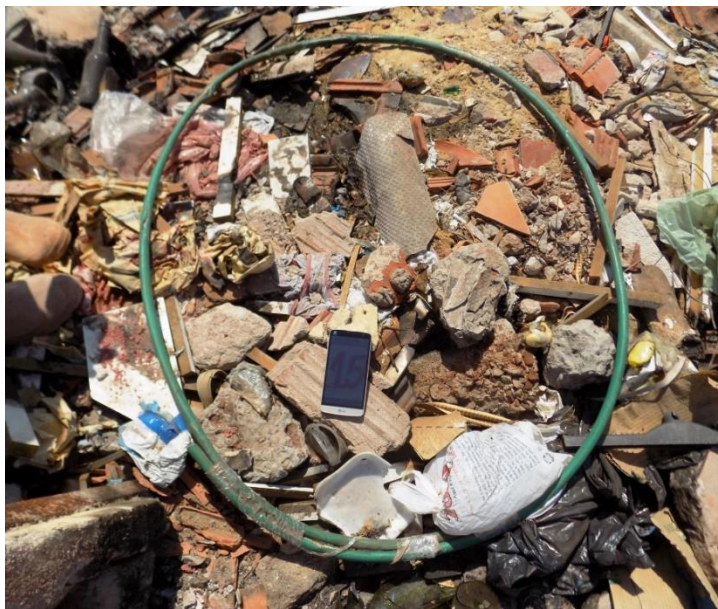
Figura 16 - Amostrador circular com 1 metro de diâmetro demarcando ponto.
