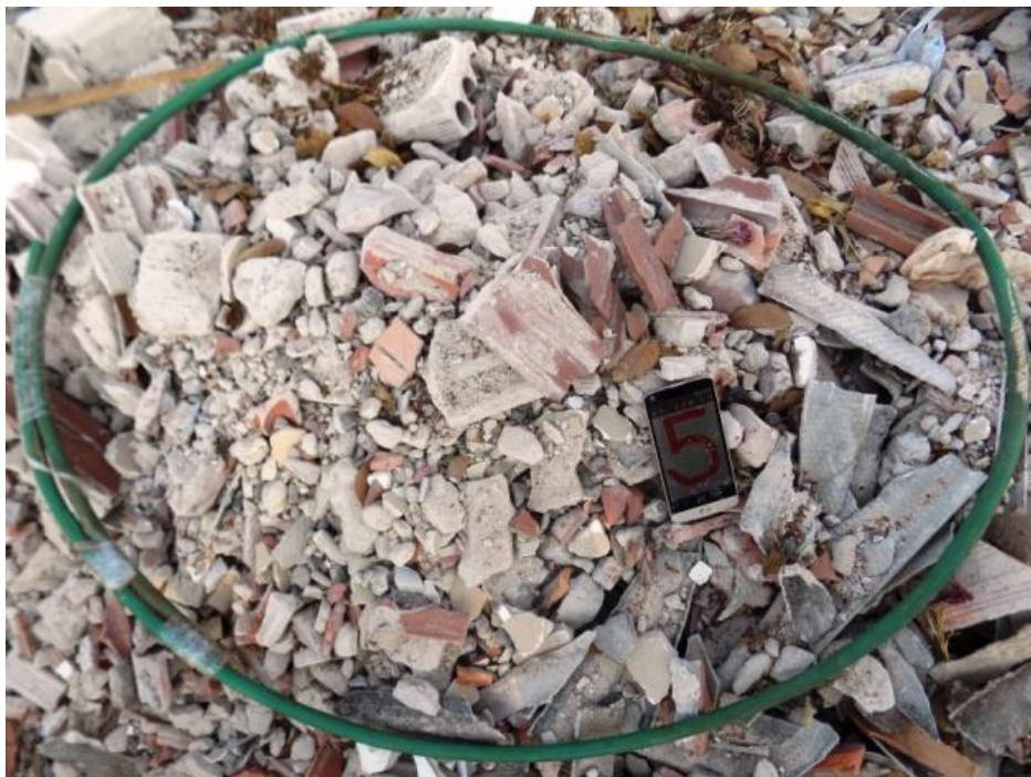
Figura 36 - Predominância de resíduos de alvenaria no ponto amostral.
