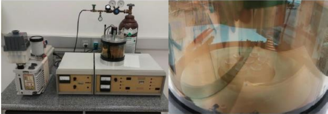
Figura 17 – Equipamento para recobrimento com ouro, Sputter Coater EMITECH, K450.
