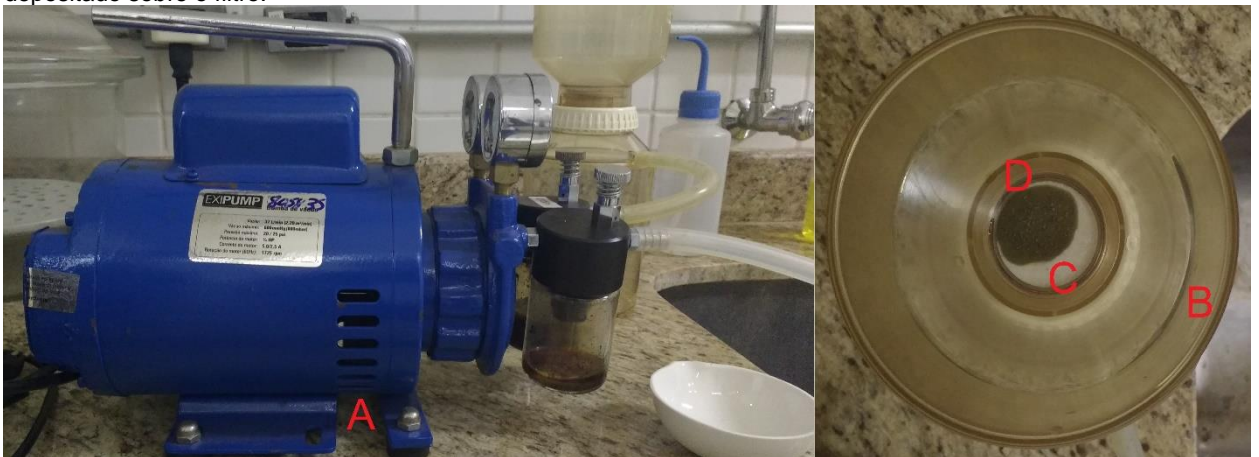
Figura 14 – Filtração. A: Bomba a vácuo; B: suporte do filtro; C: papel filtro; D: material precipitado da solução, depositado sobre o filtro.
