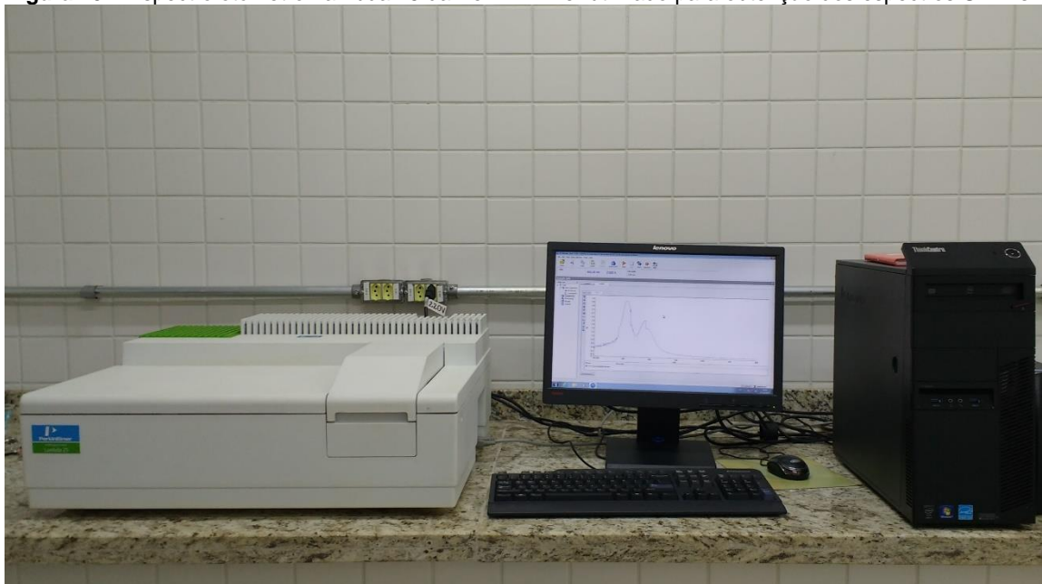
Figura 20 – Espectrofotômetro Lambda 25 da Perkin-Elmer utilizado para obtenção dos espectros UV-Vis.
