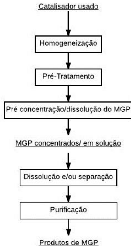
Figura 6 - Fluxograma genérico de processos hidrometalúrgicos de recuperação de metais.
