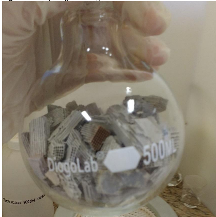
Figura 12 - Peça fragmentada, pesada e inserida no balão volumétrico de fundo redondo.
