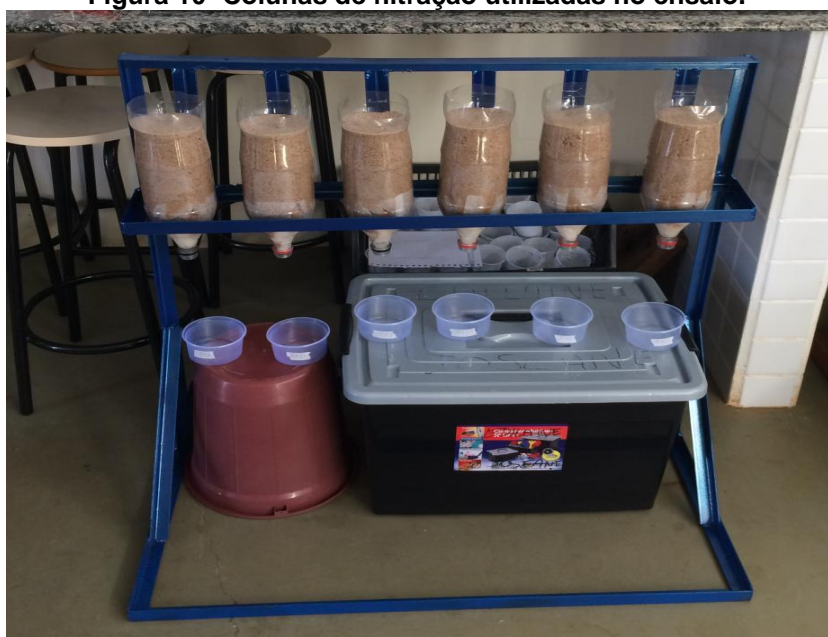
Figura 10- Colunas de filtração utilizadas no ensaio.
