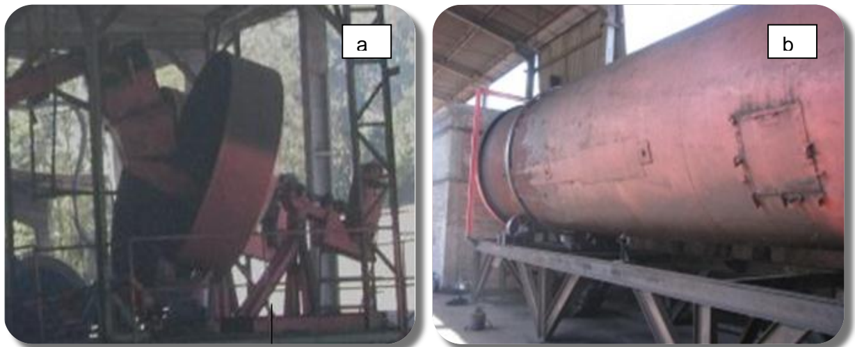
Figura 5 – a) Granulador; b) Secador da empresa na empresa X. Fonte: CMB Consultoria Ltda. (2012).
