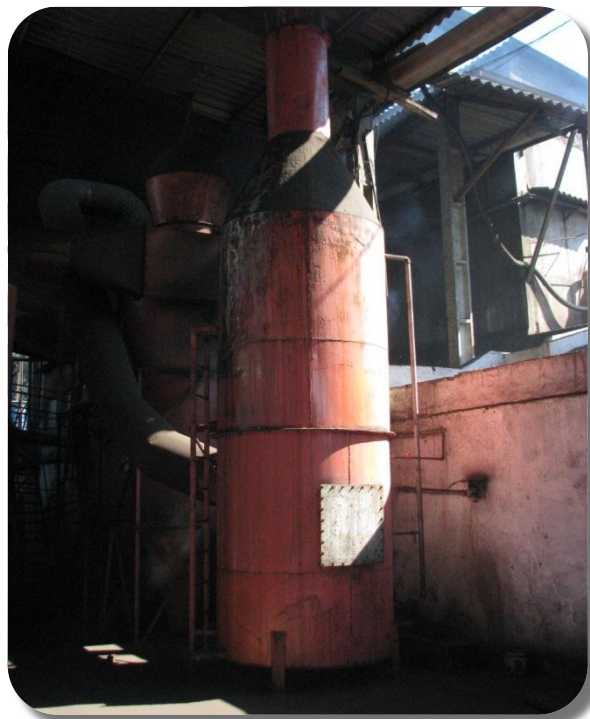
Figura 14 – Primeiro lavador de gases fabricado pela empresa X. Fonte: CMB Consultoria Ltda. (2012).
