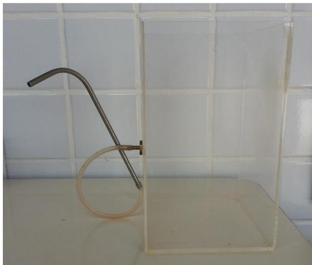
**Figura 8: Jarro do jar test com mangueira de coleta de dados**
