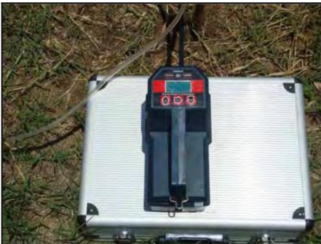
Figura 6: Analisador GASTECH, modelo INNOVA Series. Fonte: Viação Garcia 2013.
