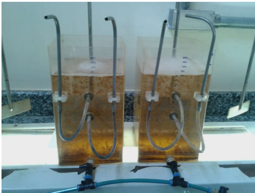
Figura 8 – Ensaio sendo executado no Jar-Test no momento da geração dos flocos
