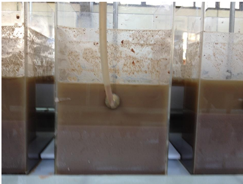
Figura 9: Visível sedimentação dos sólidos utilizando o Sulfato de Alumínio
