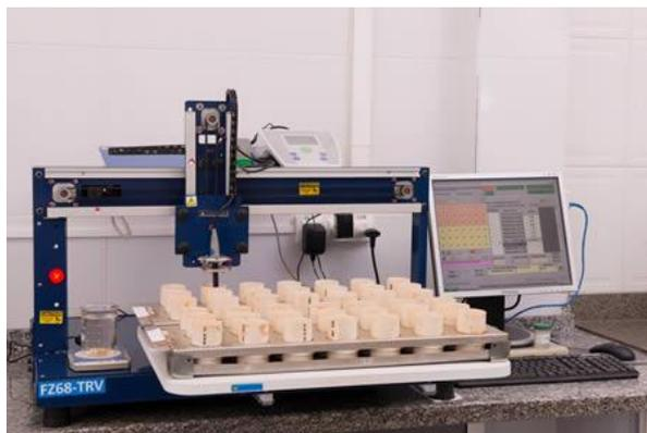
**Figura 19 - pHmetro utilizado pelo laborsolo**
