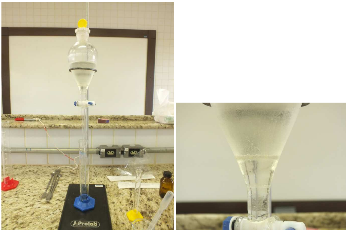
Figura 9 - (a) Estrutura de extração de contaminantes com funil de separação; (b) Separação das fases.
