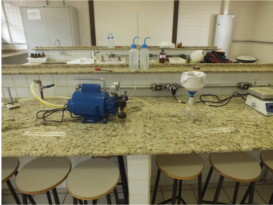
Figura 7 - Secagem da amostra de solo em sistema de vácuo.
