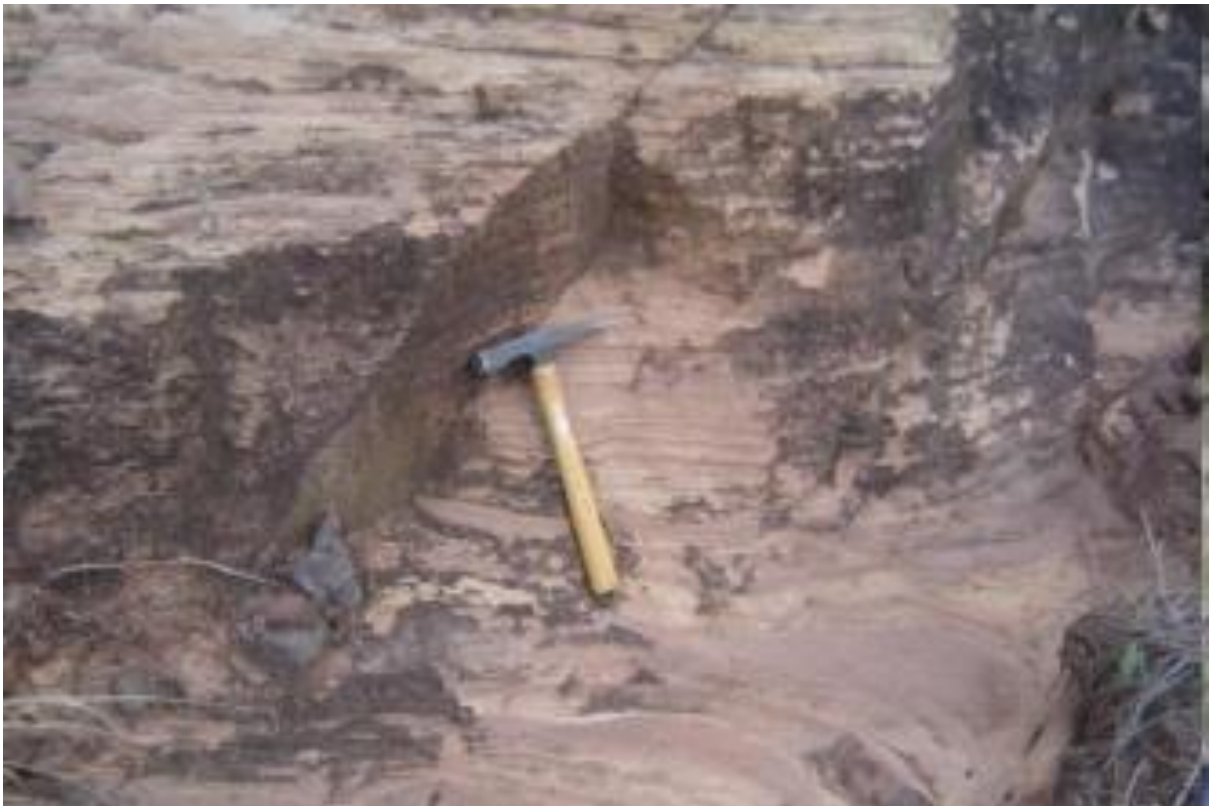
Figura 2 - Afloramento de arenito da Formação Botucatu, destacando algumas estratificações cruzadas e as fraturas.
