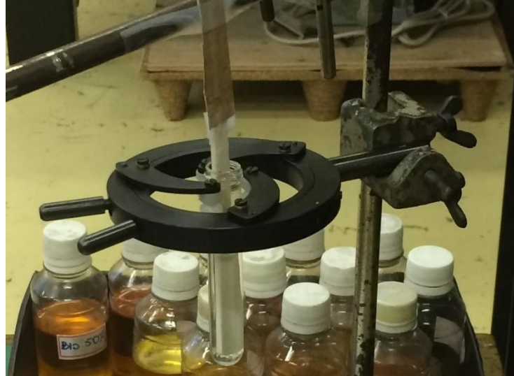
Figura 7 - Foto da garra em anel que serve de suporte para o tubo de ensaio.
