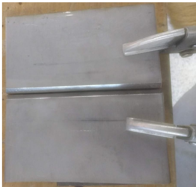
Fotografia 2 – Fixação das amostras para soldagem, utilizando dois alicates de pressão.
