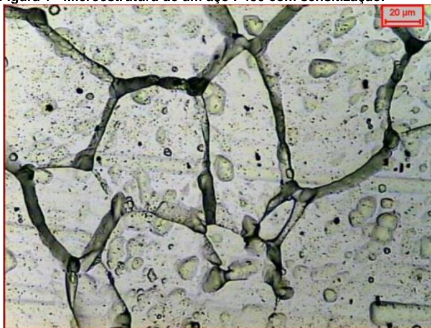
Figura 1 - Microestrutura de um aço P430 com sensitização.
