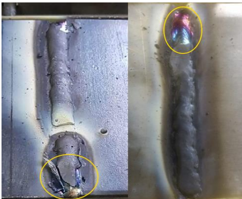
Figura 15 - Aspecto da escória da junta soldada.
