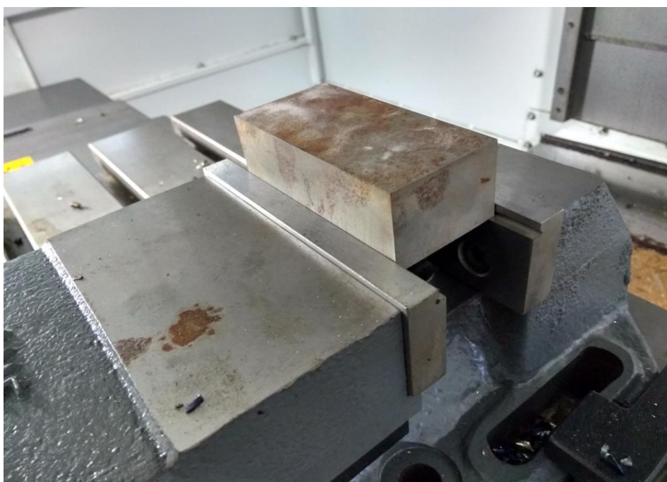
Figura 10 - Fixação do corpo de prova
