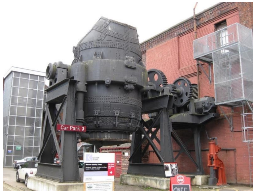
Figura 3 - Forno de Bessemer
