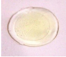
Figura 3.8 - Deposições de 0,1 ml de resina fotocurada Fonte: Autoria própria.
