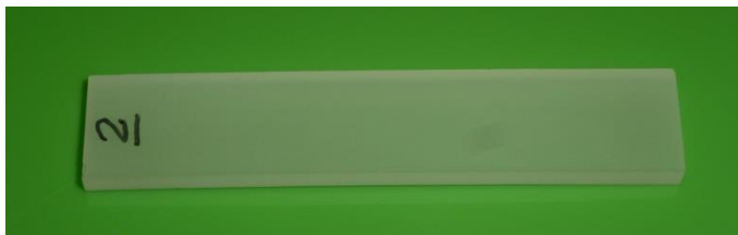
Figura 3.33 – Padrão do corpo de prova para ensaio de flexão Fonte: Autoria própria
