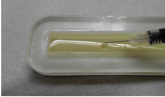
Figura 3.21 – Teste de toque para verificação da polimerização superficial Fonte: Autoria própria.
