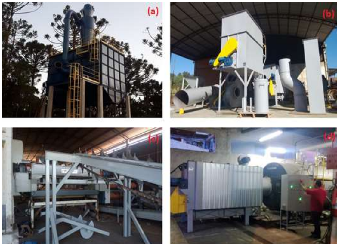
Figura 14 - Componentes fabricados pela empresa, (a) Filtro de Mangas. (b) Conjunto de partes caldeira: Silo dosador, tubulações, ventilador, exaustor. (c) Alimentadores de laminador de madeira. (d) Queimador de cavaco. Fonte: Autoria própria,2017.
