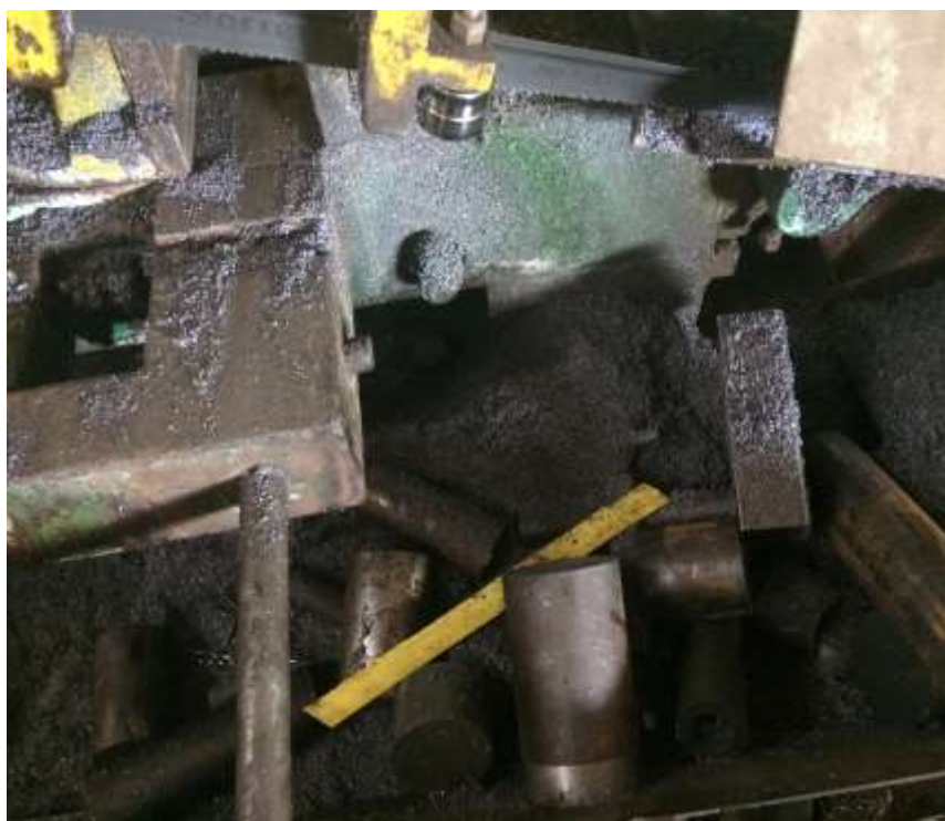
Figura 23 - Matéria-prima e pó metálicos misturados.
